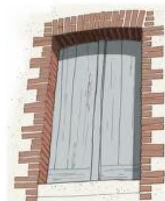
Linteau en arc segmentaire et harpage en briques 24, rue d'Anjou
